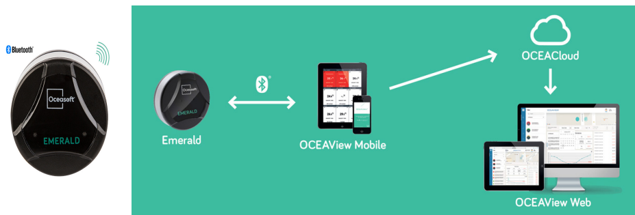
[그림 7] 콜드체인 데이터 로거 에메랄드와 스마트폰 연계 모니터링 모습
